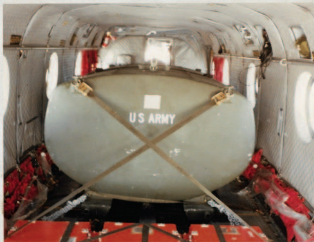
TANQUES SUPLEMENTARIOS DE COMBUSTIBLE DEL CHINOOK
